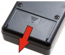
Dé la vuelta a la caja y, ejerciendo una ligera presión con el pulgar, presione sobre la zona estriada y deslice la tapa hacia la parte inferior de la unidad.
